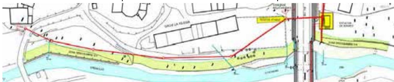
Imagen del emisario y los pozos fuera de la zona de servidumbre del río Oroncillo.
